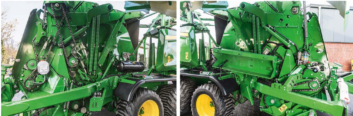
Auf der linken Maschinenseite befindet sich der Antrieb der Presskammer. Die Ketten sind mit sehr guten Einstellhilfen versehen (Foto links). Auf der rechten Pressenseite befinden sich der Rotor- und Pickupantrieb sowie die Zentralschmierung (Foto rechts).
