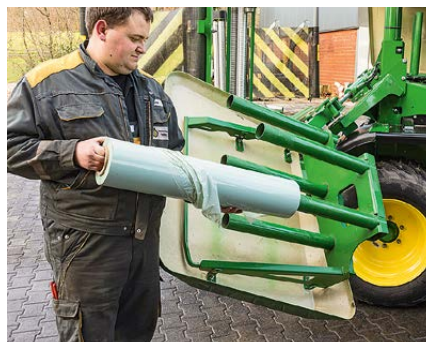
Das Magazin schwenkt hydraulisch in die richtige Richtung aus, so lassen sich die Folien rückschonend handhaben.
