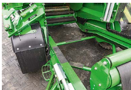
Die Antirutsch-Flächen erleichtern den Einstieg in die Kammer beträchtlich.
