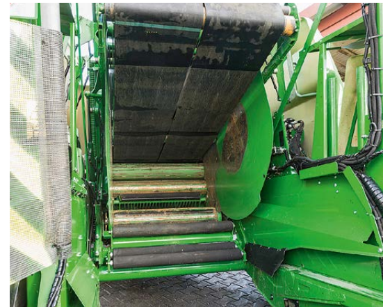
Die Presskammer hat zwei breite Riemen und drei Presswalzen. Die Seitenbleche komplettieren die Kammer, eine Heckklappe gibt es nicht.
