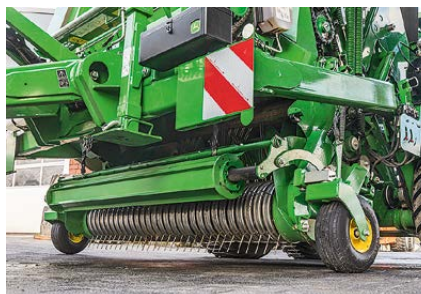
Die Pickup und der Rotor bilden einen abgestimmten und leistungsfähigen Einzug.
