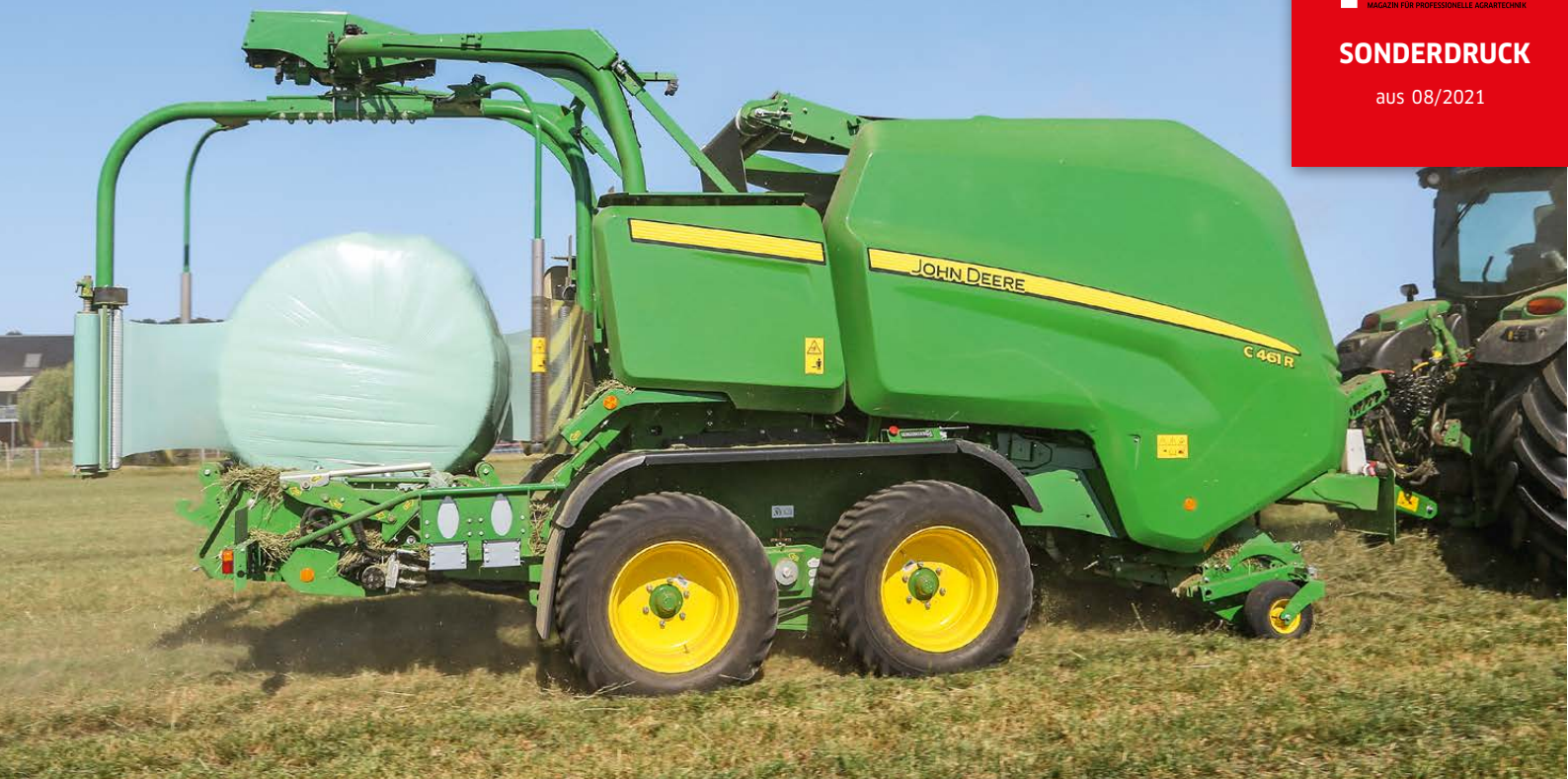
Die Presswickel-Kombination C461R kann bis zu 60 Ballen in der Stunde formen und wickeln. Fotos: Tovornik, Brüse
