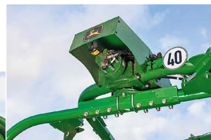
Der Wickler ist massiv ausgeführt und schnell. Der Antrieb erfolgt hydraulisch.
