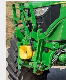
Vorbildlich: guter Oberlenkerhalter und Bolzen der Unterlenker ohne lose Splinte.
