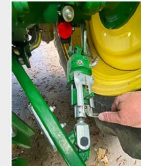
Lästig: hydraulische Stabis, aber Kurbeln zum Kat.-Wechsel.
